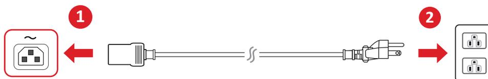
1. Conecte el cable de corriente al conector AC IN (entrada de CA) de la parte posterior del dispositivo.
