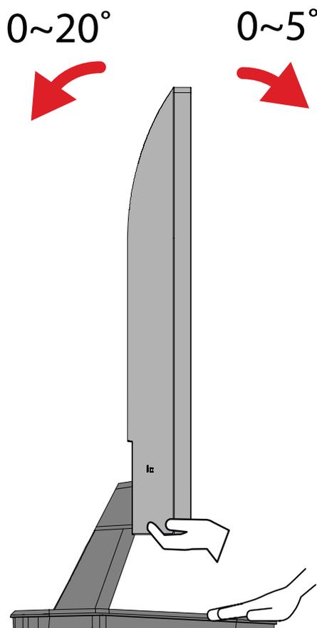
**NOTA:** Cuando realice el ajuste, sostenga el pedestal firmemente con una mano mientras inclina el monitor hacia delante o hacia atrás con la otra.
