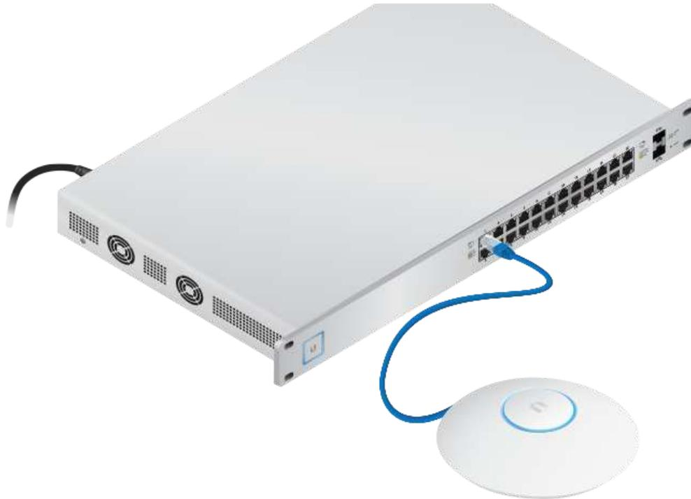
*Diagrama de conexión de alimentación a un interruptor UniFi con PoE*
