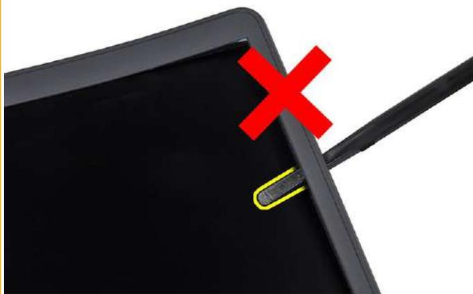
3. Levante el bisel de la pantalla para quitarlo del ensamblaje de la pantalla.
